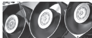
Lüfter in einem Dauerlaufschrank von ebm-papst. 1500 Lüfter werden hier bis zu deren Ausfall in Temperaturschränken betrieben.
